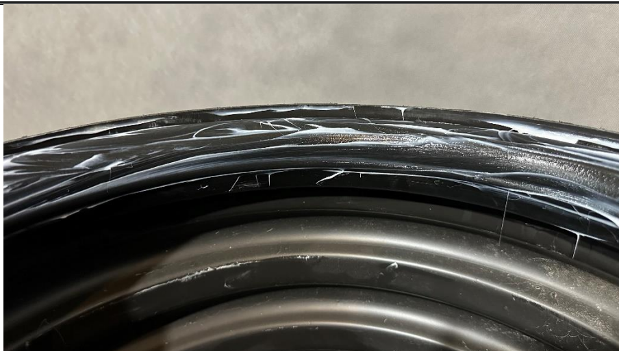
Rys.6 - Aplikacja smaru poślizgowego na uszczelce w celu instalacji zatyczki - T4/600/Z.
